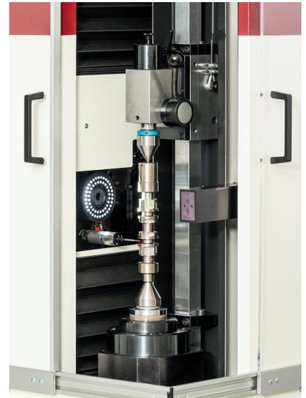
**Aufrüsten möglich:** Mit dem taktil scannenden Messtaster SP25 wird die WMM 450 von einer 2D- zu einer 3D-Wellenmessmaschine.
